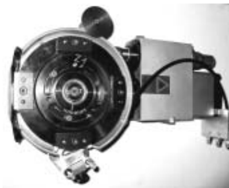
Bild 2: Messerhalter mit Schnellwechselfvorrichtung für Rasierklingen- und Scherenschnitt
